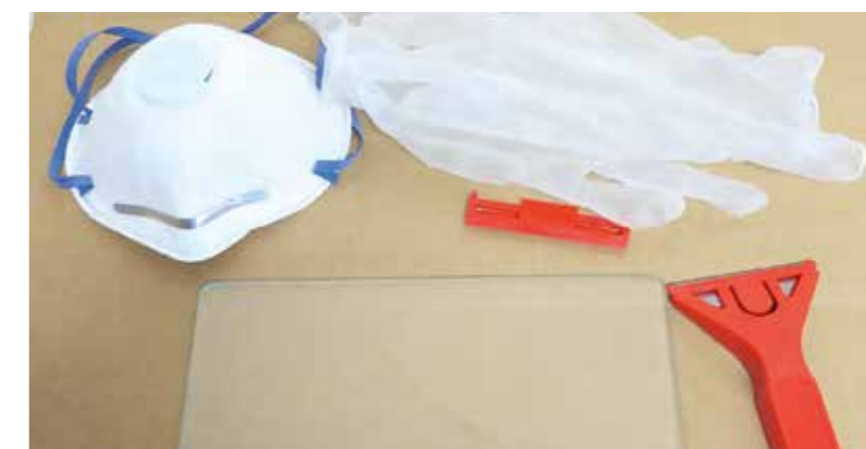
Myrkyä poistamiseksi lasilevyiltä tarvitaan hyvät suojaimet ja kaavin, jolla kuivunut myrkyä raaputetaan lasilta talteen.
